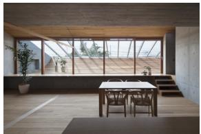
この場所にある光,熱,風,水,音の循環の一部となるように、SOUTH 簡潔な形状で自然と呼応する建築である。南側サンルーム は交通量の多い前面道路の騒音と排気ガスの緩衝空間であ ると同時に、冬に暖かい温室、夏に涼しい日陰をつくる。 低層戸建住宅地を見下ろす3階北側の窓からは夏の涼風が 取り込まれ、家全体を吹き抜ける。建築全体が光のリフレク ターとなり、風の整流装置となっている。
